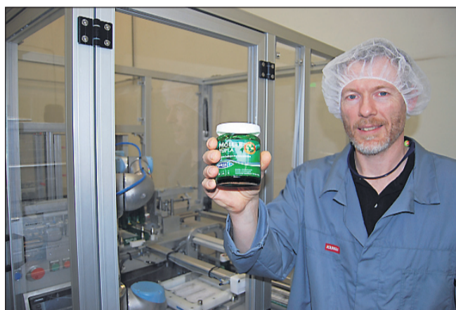
- Fiskeolieproduktet pakkes via robotten, der er indstillet, så den kan køre i flere forskellige typer af vitamin- og helseprodukter og i flere forskellige antal. Robotten har en cyklustid på omkring 10 sekunder, hvilket betyder, at vi får cirka 70 produkter igennem per minut, siger Carsten Bo Nielsen, pakkeri- og vedligeholdsleder hos Axellus.
